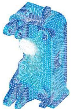
ボックス構造とFEM解析を最大限活用し、プラテン及びマシンベースの剛性を大幅に向上させました。特にプラテンはたわみ量を従来機比60%も低減させることで、バリレス化を実現するとともに、さらに従来よりワイド化することで、より大きな金型を搭載することができ、クラスダウンも可能となります。
