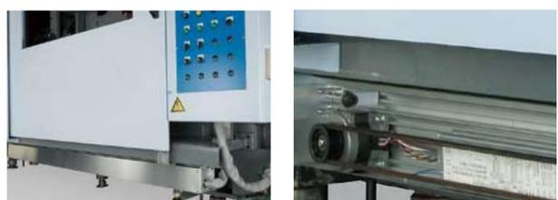
操作側の安全ドアの自動開閉装置に電動式を採用し、かつ標準装備としました。スムーズかつ迅速な動作で、作業性向上に貢献します。従来機より60%速度アップ。さらに成形機本体はエアが不要となります。
