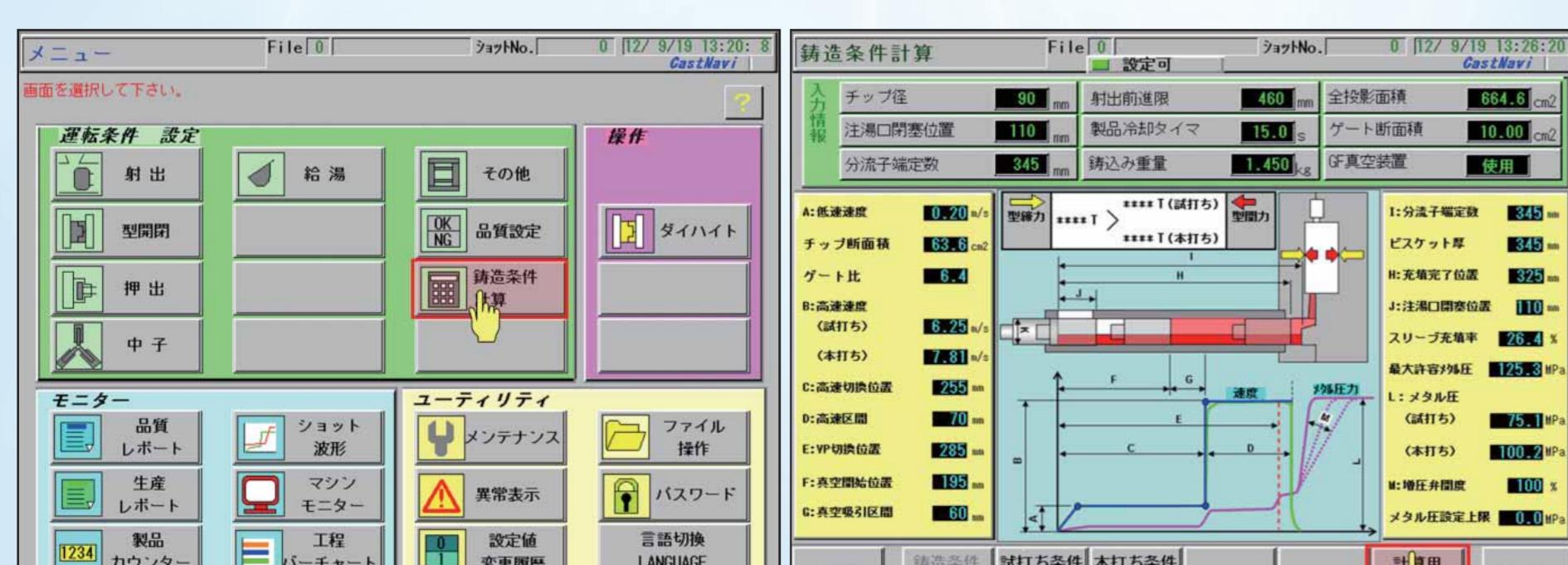
UB-iS2シリーズに鋳造条件計算機能を新搭載!「標準設定モード」と「簡単設定モード」の2種類のモードを準備。設定方法について分かりやすく解説します。
